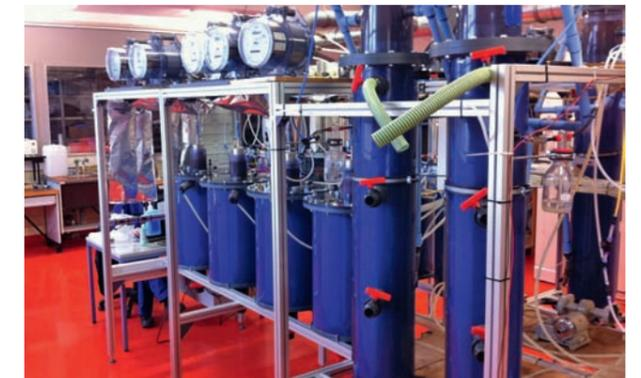
Abb. 3: Versuchsstand zum anaeroben Abbau von Arzneimitteln aus Schwarzwasser. Foto: Bauhaus-Univ. Weimar
