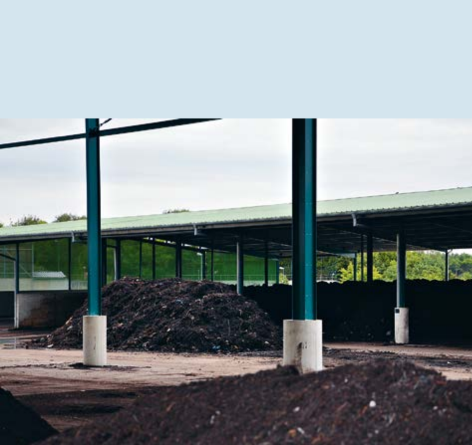
Nachrotte: Der Gärrest wird hygienisiert und sechs bis acht Wochen kompostiert. Der Kompost wird zur Gewinnung von Erden genutzt, die im Raum München verkauft werden. Ein Beispiel für echte Kreislaufwirtschaft
