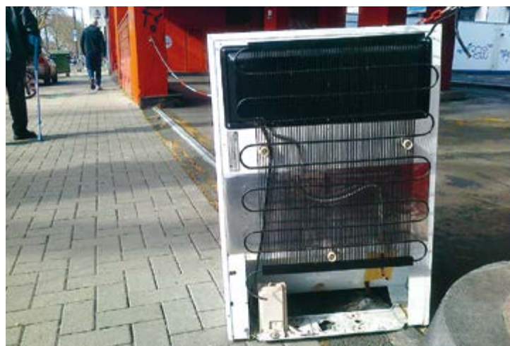
Beraubte Kühlgeräte, denen der Kompressor entnommen wurde, können zu einer nicht unerheblichen Freisetzung von FCKW führen
