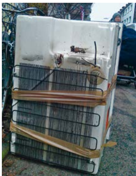
Beraubte Kühlgeräte, denen der Kompressor entnommen wurde, können zu einer nicht unerheblichen Freisetzung von FCKW führen
