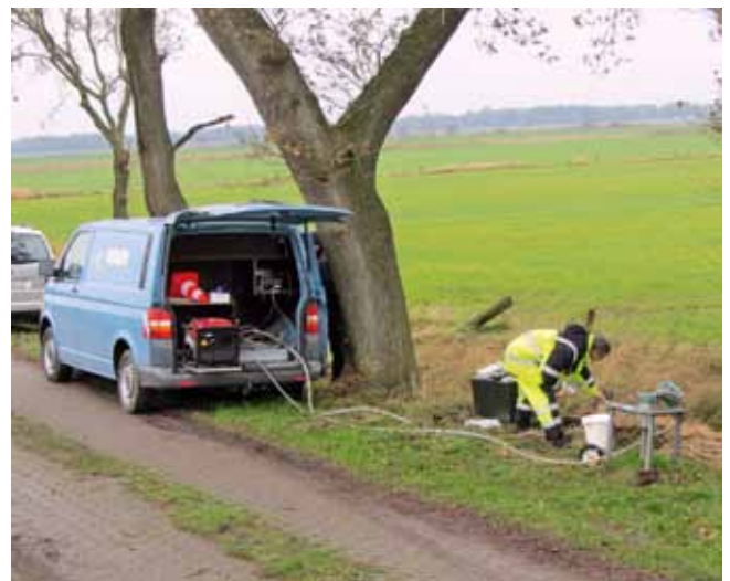
Abb. 3: Messung der Versalzung des Grundwassers, Foto: H. Wiederhold
