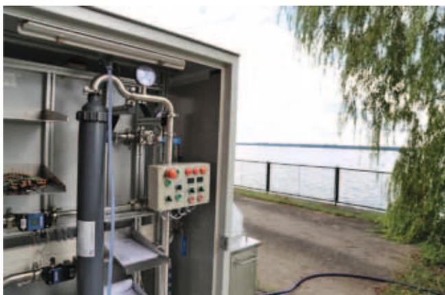
Abb. 2: Pilotanlage zur kontinuierlichen Crossflow-Ultrafiltration im Berliner Wasserwerk Friedrichshagen. Foto: Daniel Karthe
