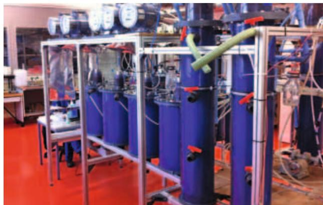
Abb. 3: Versuchsstand zum anaeroben Abbau von Arzneimitteln aus Schwarzwasser. Foto: Bauhaus-Univ. Weimar
