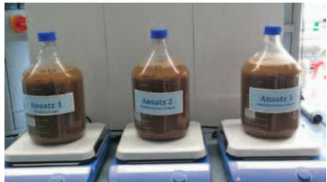
Abb. 1: Geräteaufbau für die Labor-Zehrungsversuche. Foto: B. Cybulski
