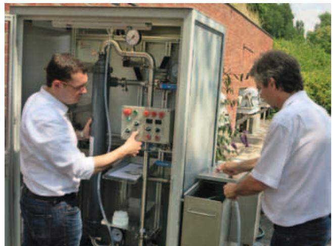
Abb. 1: Inbetriebnahme der kontinuierlichen Crossflow-Ultrafiltration. Foto: Daniel Karthe
