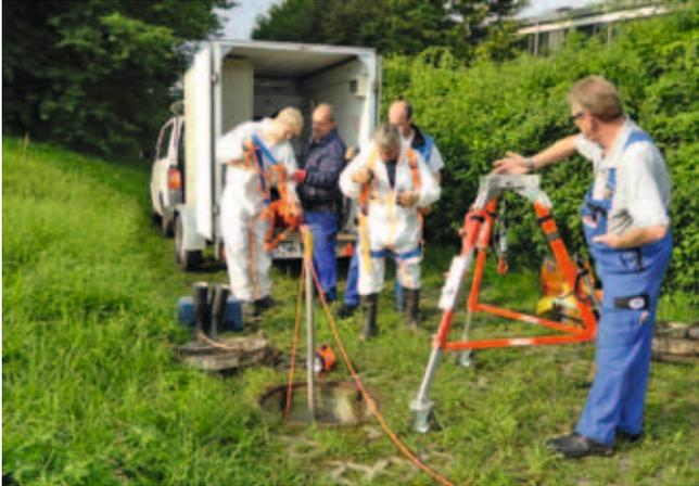
Abb. 2: Einrichtung einer Messstelle für Qualitätsmessungen an einem Regenüberlaufbecken. Foto: Universität Stuttgart, ISWA
