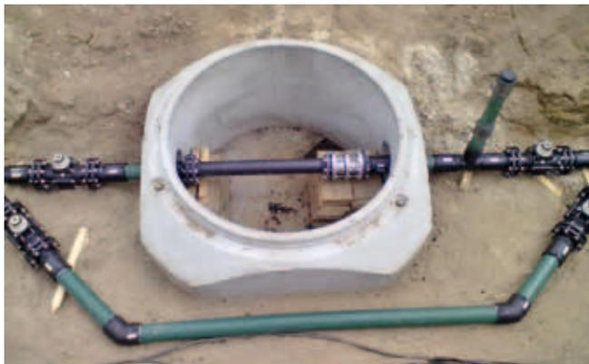
Abb. 1: Teststrecke zur Überwachung von Inkrustationen im Unterdrucksystem. Foto: HAMBURG WASSER
