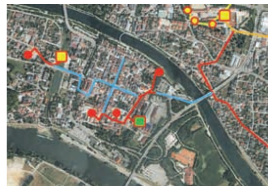
Geplantes Fernwärmenetz in der Altstadt von Kelheim
