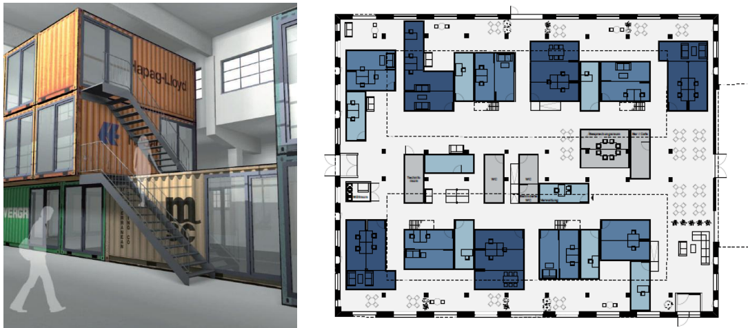
Abb. 7: Experimentelle Form flexibler Raumlösungen ( Existenzgründerzentrum Alter Schlachthof Karlsruhe
