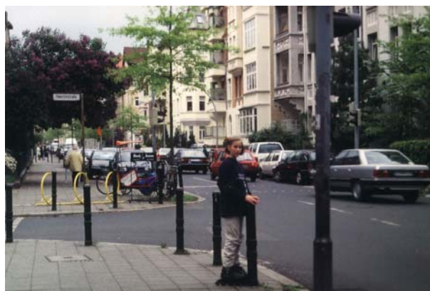
Bild 4-10: Vorgezogene Seitenräume im Tempo 30-Gebiet (Braunschweig)
