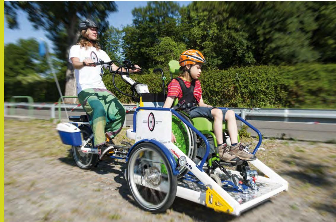
Beim Fahrdienst mit Rikschas, die für Rollstühle geeignet sind, ist die Beförderung auf der Vorderachse üblich.
