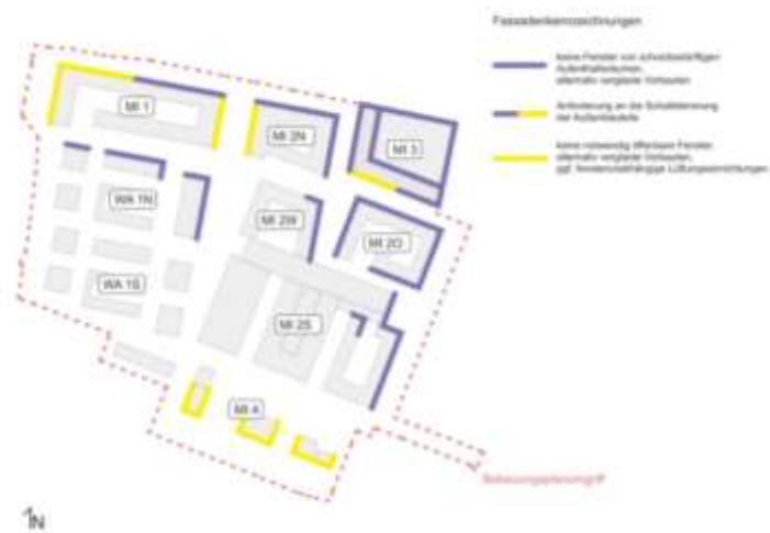
Abb.3: Fassadenkennzeichnung für erforderliche Schallschutzmaßnahmen im 2. bis 4. OG
