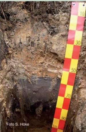
Abbildung 1c: Gestörter Wasserhaushalt; Humus im Unterboden
