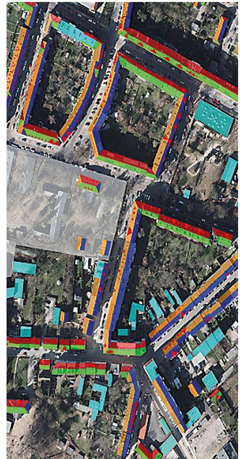
Abbildung 13: Auszüge aus dem energetischen Quartierskonzept „Werdervorstadt“ der Landeshauptstadt Hannover zur Nutzung erneuerbarer Energien. Links: In Kopplung mit der Fernwärmeversorgung im Schweriner Stadtteil Werdervorstadt. Rechts: Ausschnitt aus der Solarpotenzialanalyse der Gebäudedächer im Quartier.
