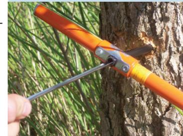
Entnahme von Bohrkernen mit einem Zuwachsbohrer: zur Charakterisierung der Grundwasserbelastung
